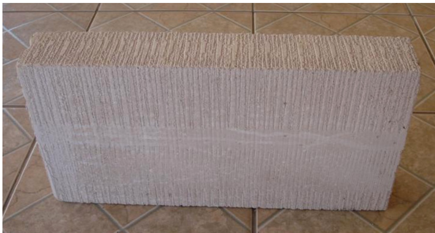
Figura 3 – Bloco de concreto celular autoclavado (60 x 30 x 10cm)
