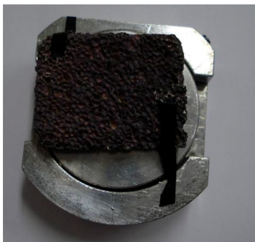
Figura 4 – Amostra do bloco BCCA (4 x 2 x 0,5 cm) recoberta com ouro
