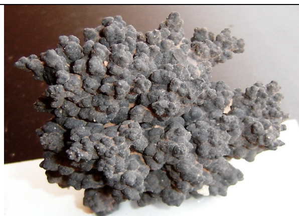
Figura 5 - Aspecto botrioidal da mineralização manganosífera (amostra com 9 cm)
