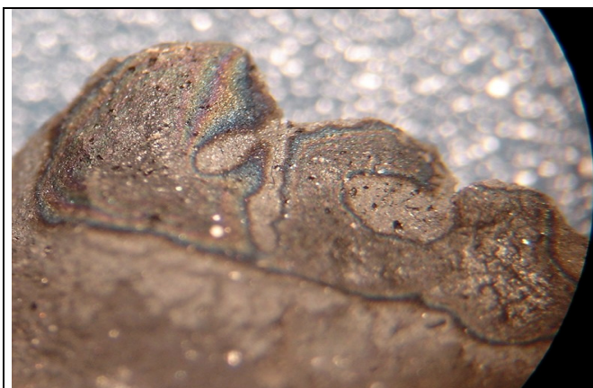
Figura 4 - Irização da mineralização manganosífera e brilho metálico ao microscópio estereoscópio (40x)
